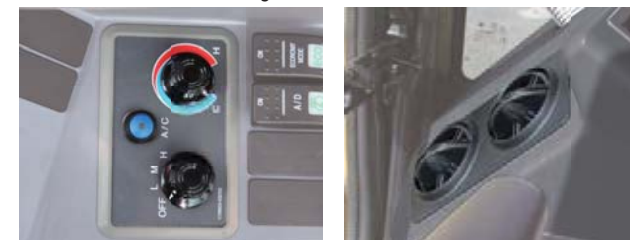
Cuadro de control del aire acondicionado
