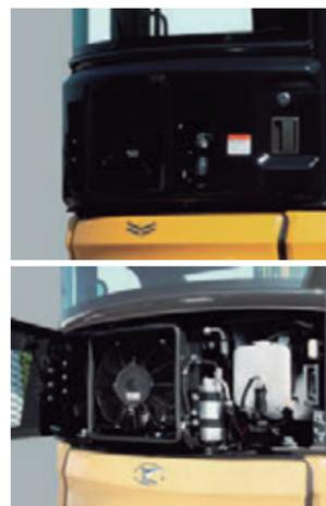
**[Condensador del aire acondicionado]**
